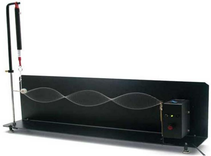
Considerando a onda estacionária gerada no momento em que a foto do experimento foi registrada e o fato de, nesse instante, o dinamômetro indicar uma força de tensão de 156,25 Newtons, a frequência de vibração da fonte é igual a
