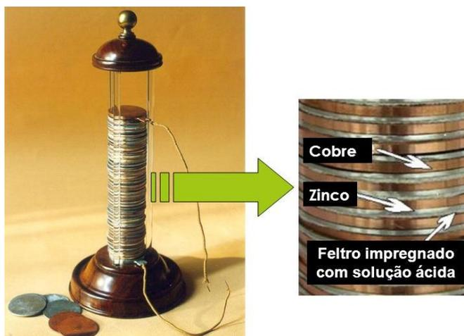
**32.** O cátodo na pilha montada por Volta é o
